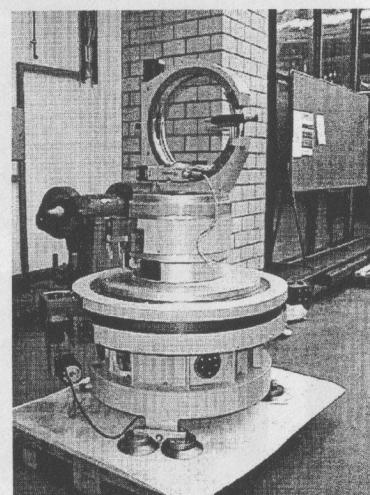
Probentisch für das Einkristalldiffraktometer.
