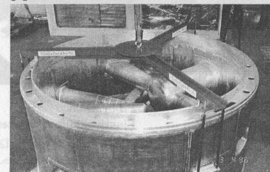
Der D<sub>2</sub>O Moderatortank mit den eingeschweißten Strahlrohren.
