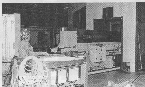
Mit der Lademaschine wird ein Einschub in das Einschubgehäuse der D<sub>2</sub>-Quelle eingeschoben.
